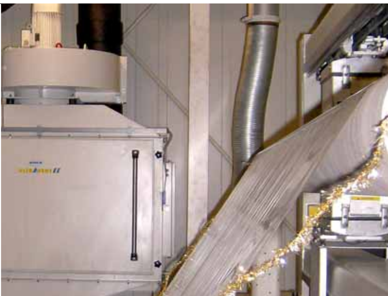
ULTRAVENT® UV-II 5000/EE Filteranlagen an einer Maschine zur Herstellung von Folien Absaugung von Paraffinen und Monomeren (Weichmacher)
