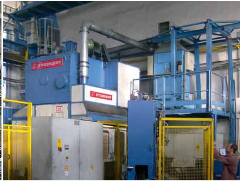
ULTRAVENT® UV-II 4000/EE Dezentrale Filteranlage für eine Schmiedepresse Absaugung von Ölnebel (Rauch)
