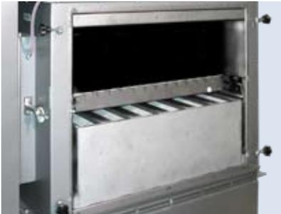
mit extremer Abscheideleistung verfügbar. Für zahlreiche Anwendungen stehen Sonderfilterzellen (z. B. mit Drainagegewebe zur Emulsionsabscheidung) zur Verfügung. Fragen Sie unseren Fachberater nach der passenden KMA Zelle für Ihren Einsatz.
