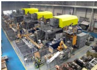
Beim zentralen Absaugkonzept sind mehrere Maschinen an einer einzigen Filteranlage angeschlossen. Die Investitionskosten für einen Zentralfilter sind i. d. R. geringer als für mehrere kleinere Filteranlagen. Allerdings müssen die Kosten für Rohrleitungen mit berücksichtigt werden. Auch ist die Leitungsführung bei großen Luftkanälen manchmal problematisch.
