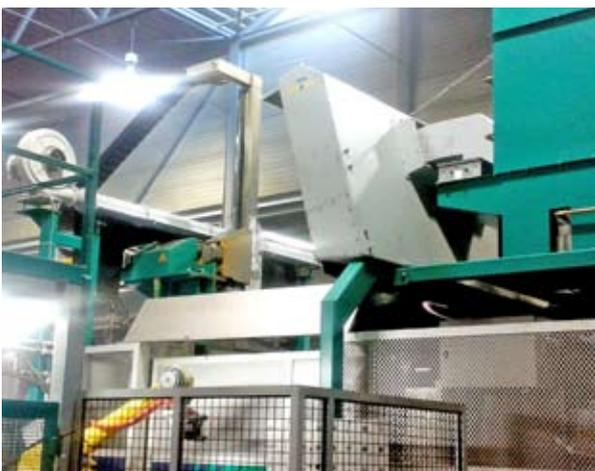
Luftschleieranlagen benötigen in der Regel eine höhere Absaugleistung als eine vergleichbare Absaughaube, denn sie verfügen nicht über die Möglichkeit, durch Thermik nach oben aufsteigenden Rauch zu puffern. Dem steht der Vorteil entgegen, dass die Arbeitsfläche nicht durch eine Absaugvorrichtung abgedeckt oder eingeschränkt wird.
