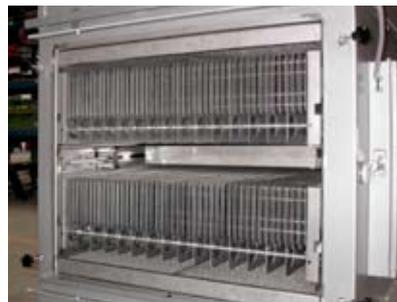
Trennölen entstehende „blue haze“ wird sauber abgeschieden. Die Filterzellen zeichnen sich durch sehr robuste Bauweise aus: Rahmen, Elektroden und Tragstangen aus Edelstahl, Kollektoren wahlweise in Aluminium oder Edelstahl, Isolatoren in ölbeständiger Keramikausführung und ein Filterdesign, das auch für die Abscheidung flüssiger oder zähfließender Substanzen optimiert wurde, machen den Elektrofilter zum äußerst wirtschaftlichen und langlebigen Filtermedium für zahlreiche
