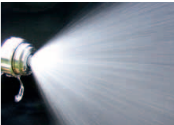
Die CIP-Düsen sind optimiert für die vollständige und hygienische Reinigung des Filterinnenraums
