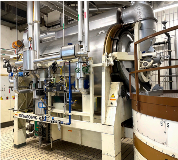
In der großen Rösttrommel wird den Kakao-Nibs die Feuchtigkeit entzogen. Rechts: Die drei KMA Gaswäscher kühlen, befeuchten und reinigen die Kakao-Abluft in Vorbereitung auf den Biofilter.
