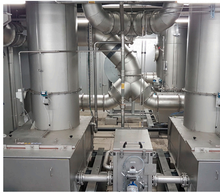
In der großen Rösttrommel wird den Kakao-Nibs die Feuchtigkeit entzogen. Rechts: Die drei KMA Gaswäscher kühlen, befeuchten und reinigen die Kakao-Abluft in Vorbereitung auf den Biofilter.
